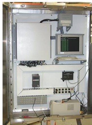
Рис. 7. Системы АЭ мониторинга фирмы PAC.
